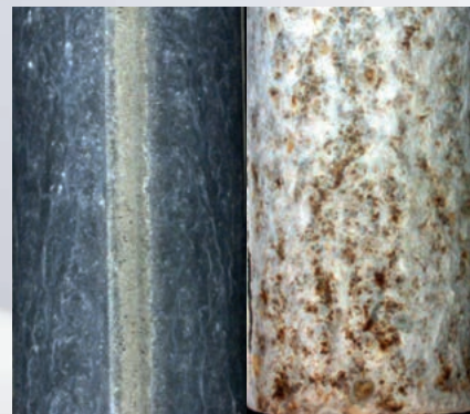
Magnelis® ZM310 stückverzinkt geschweißt und nachbehandelt zyklischer Korrosionstest (3CT) (VDA 621-415) nach einem Testzeitraum von 33 Wochen
