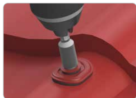
3. Anziehen bis Dichtung leicht komprimiert
